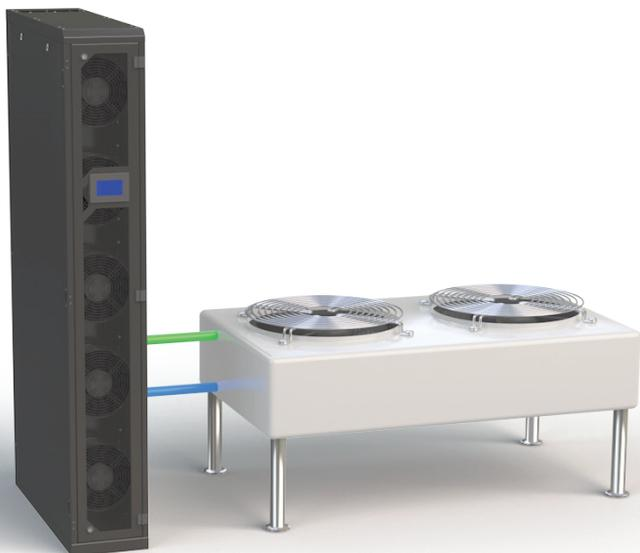
CoolTeg XC-Einheit ist mit einem Kompressor ausgestattet und jede Indoor-Einheit wird über eine Kupferkältemittelleitung an die Kondensatoreinheit im Freien angeschlossen. Moderne EC-Kompressoren und elektronische Expansionsventile werden verwendet. EC-Lüftern werden standardmäßig benutzt.
